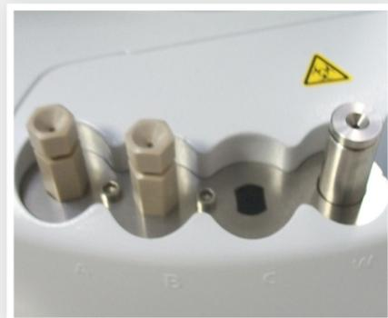
Boquillas de disolvente y de descarga
